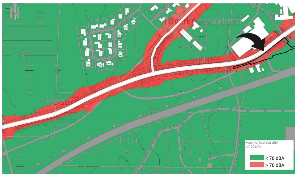
Figur 29. Maximalt buller efter omdragning av Kungsvägen. Källa: WSP.
