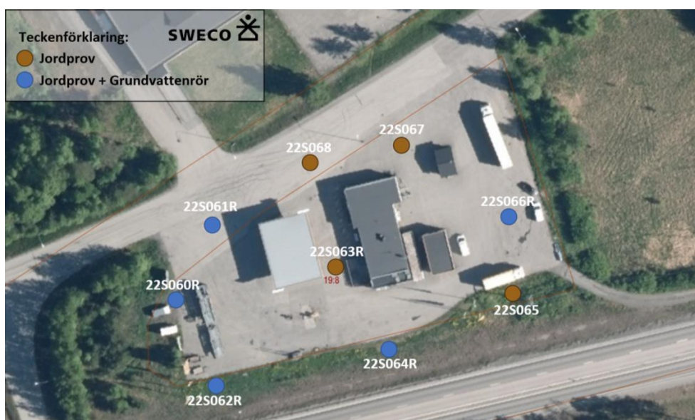
Figur 30. Illustration av provpunkter för jord och grundvattenprovtagningen. Blå cirklar beskriver punkter där jordprov uttagits och grundvattenrör satts. Orangea cirklar beskriver punkter där enbart jordprover uttagits. Källa: Sweco.
