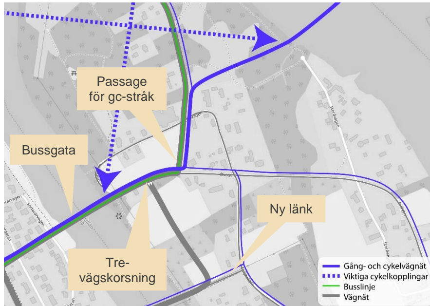
Figur 8-12 Skiss på trafiklösning Norra Ön där busstrafiken går på den befintliga bron. För att ge busstrafiken bästa förutsättningar skapas en trevägskorsning där busstrafiken har företräde.
