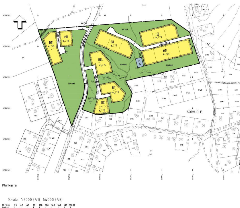
Figur 2. Detaljplan för del av fastigheten Sörmjöle 2:190. Plats för avloppsanläggning är angiven med grå rektangel.
