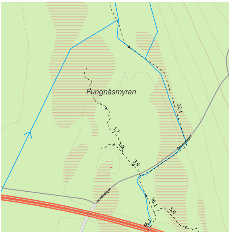
Figur 15: Framtida flödesvägar (svarta streckade linjer) och beräknade medelvattenflöden (l/s) genom Fungnäsmyran. Heldragen blå linje markerar Djupbäckens sträckning enligt Lantmäteriets topografiska karta. © Lantmäteriet.
