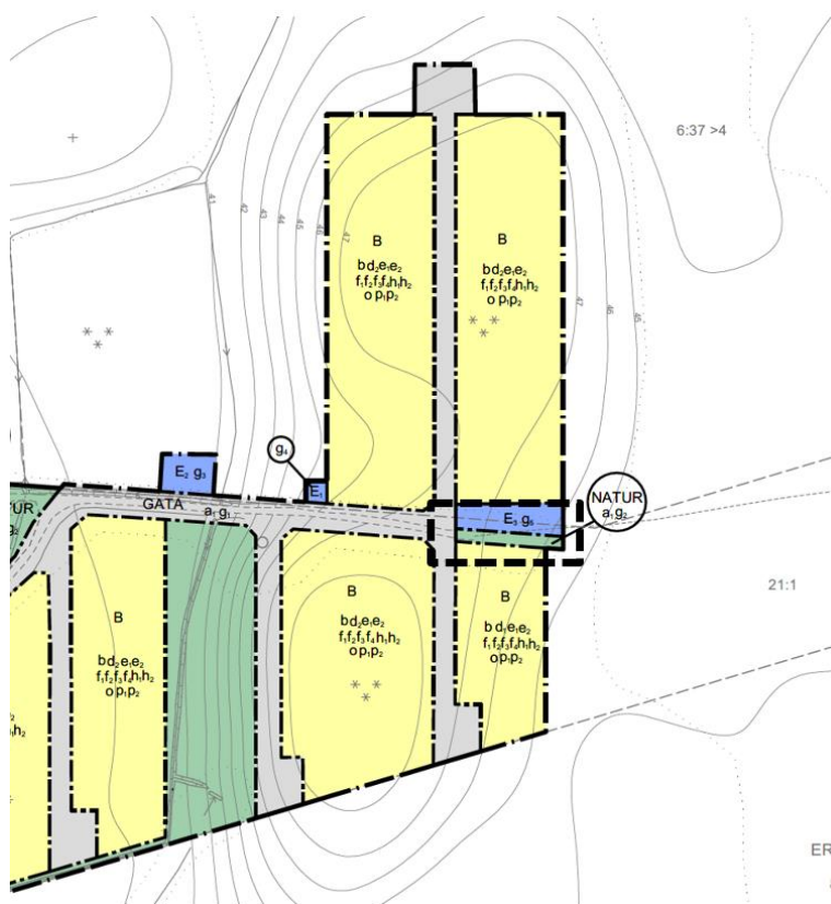
Figur 7. Släpp av naturmark (svart streckad linje) för att säkerställa boendes tillgänglighet till omkringliggande fastigheter utan att behöva inkräkta på kvartersmark
