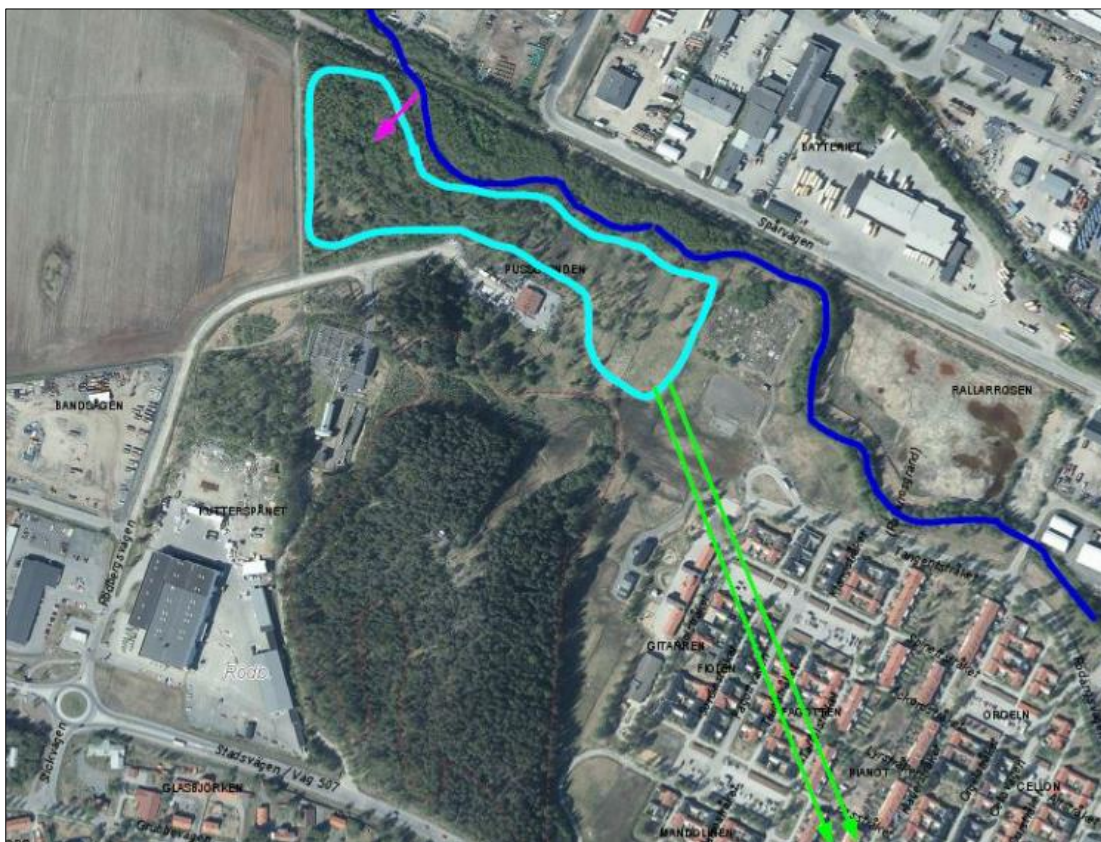
Figur 4. En intilliggande våtmark bredvid Tvärån (sammankopplade med ett överfall) med två 1200-ledningar som leder bort vattnet från våtmarken. Överfallet och ledningarna är schematiskt representerade som tre pilar (rosa överfall och gröna ledningar) och det turkosa strecket ger en ungefärlig utbredning av våtmarken i plan.
