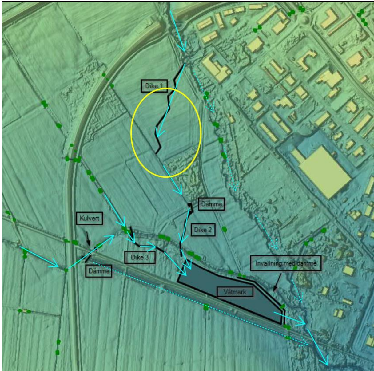
Figur 22. Möjlig översvämningssyta markerad med gul ring intill föreslaget Dike 1 (Scalco Live, 2022).
