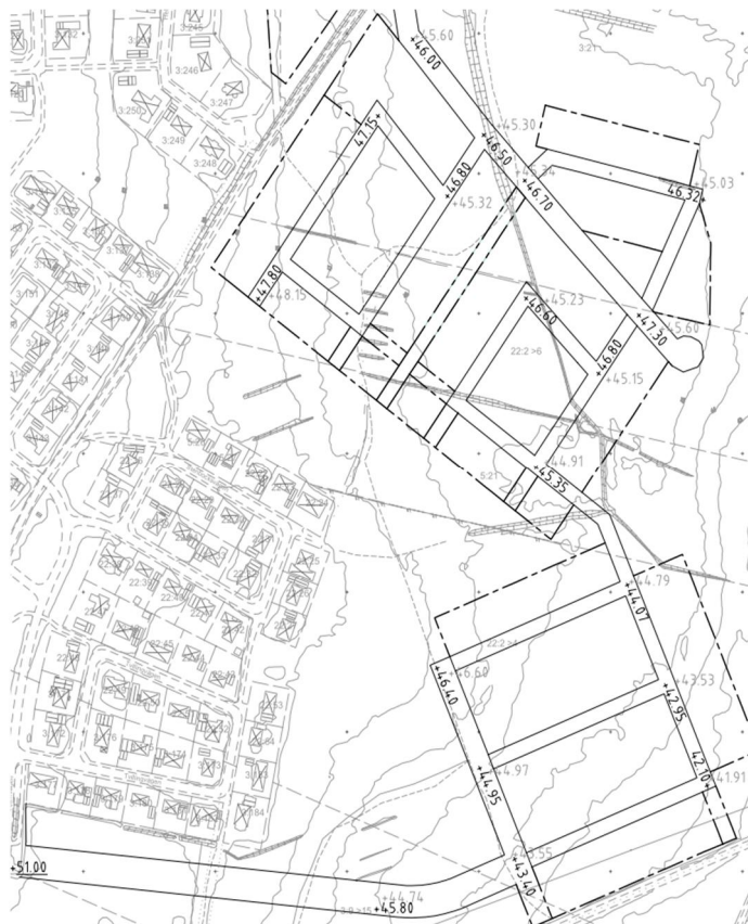
Figur 22. Höjdsättning av gator norra detaljplanen. Grå text befintlig markhöjd.
