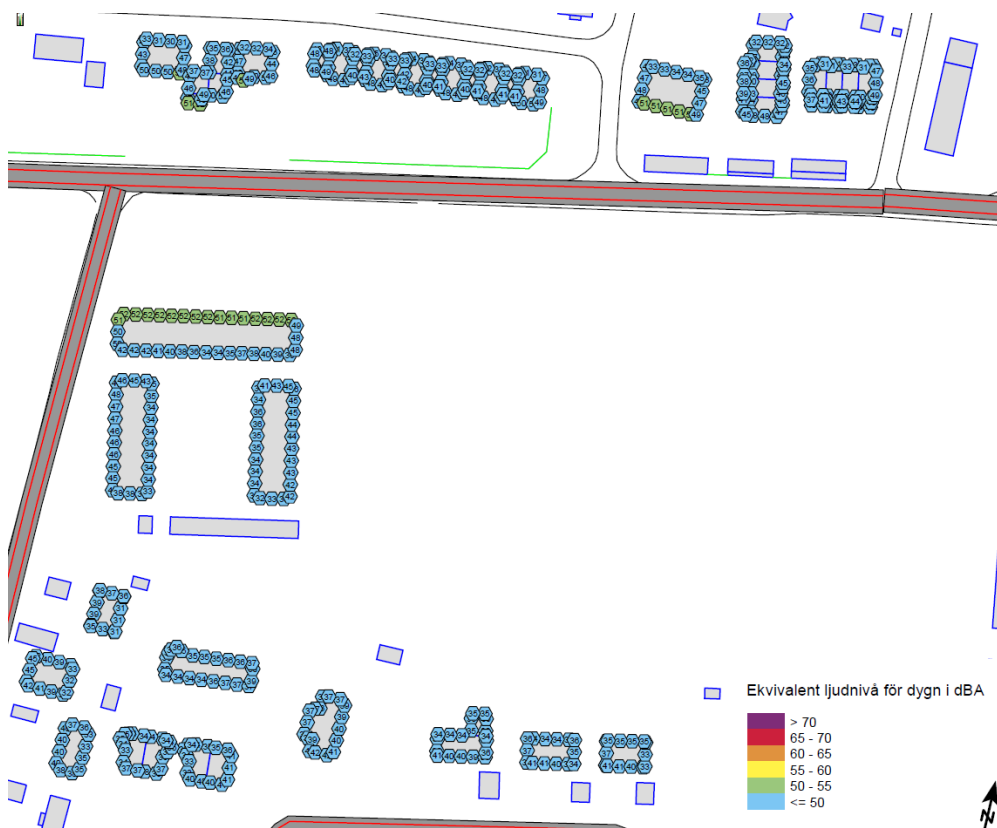
Figur 19. Utdrag ur bullerutredningen. Beräknade ljudnivåer för vägtrafik befintlig bostadsbebyggelse, ekvivalent ljudnivå, prognosår 2040.
