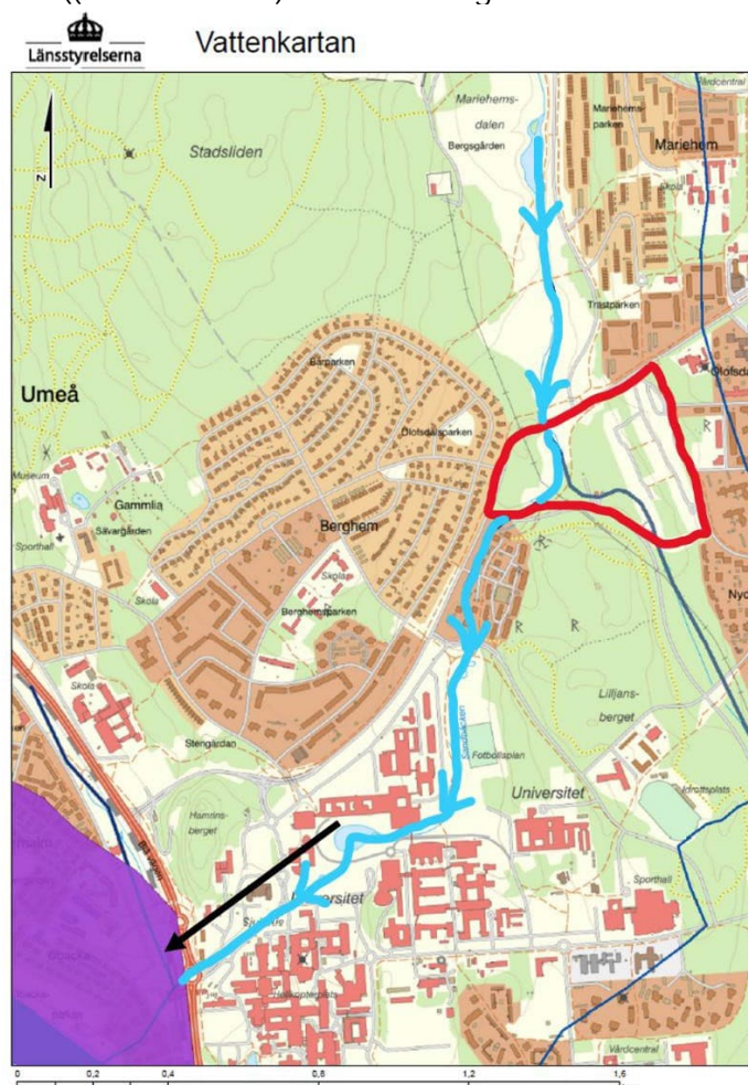
Figur 7. Översiktsbild över mottagande recipient Sandbäcken markerat med ljusblå, huvudrecipient Umeälven markerat med lila och Stadsleden 6:2 markerat med rött. Svarta pilen markerar att Sandbäcken från Universitetsdammen till sitt utlopp i Umeälven är kulverterad förutom de sista 50 m (VISS, 2023).
