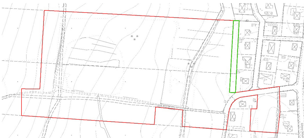
Figur 27 U-område i förhållande till plangräns. Röd färg markerar plangräns och grön färg u-området. Källa: Tyréns AB.
