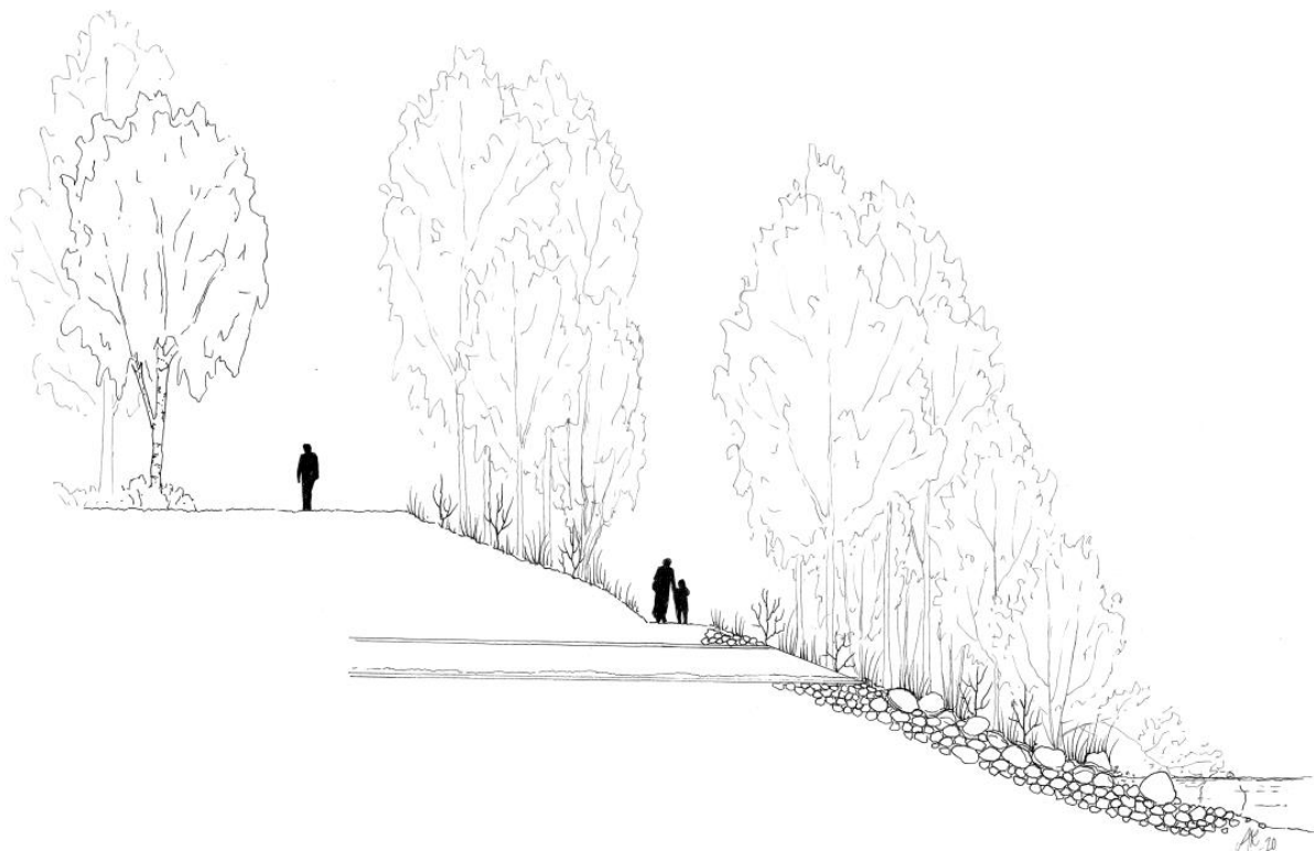
Figur 21. En sektion över ett exempel på hur utloppen kan se ut: utloppsledning, utlopp utformat som ett erosionsskyddat dike, strandskogen och älven.
