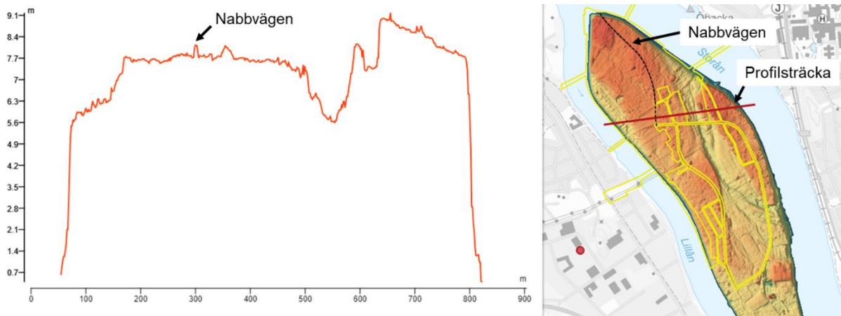
Figur 2. Terrängkarta över planområdet samt en profil dragen över planområdet (rött streck) för att illustrera hur branta älvbrinkarna är (ScalگوLive, 2022). Nabbvägen är markerad i svartstreckad linje och planområdet i gul linje.
