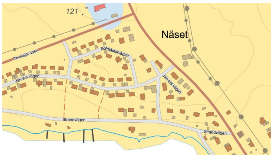
Figur 16 Utdrag ur SGU:s kartvisare för jordlager. Området kring Näset i Tavel sjö och Tavel sjö 41:1 bedöms bestå av främst lera-silt.
