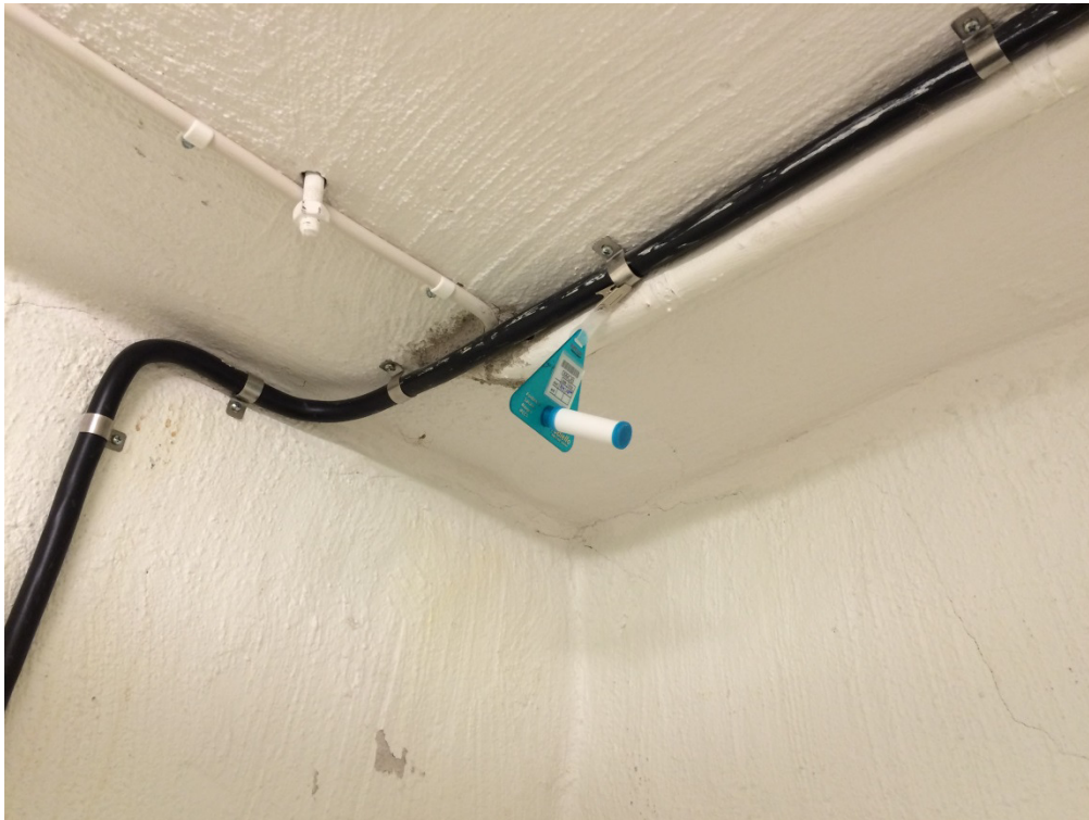
Figur 5. Passiv luftprovtagare (L2) i rummet med fettavskiljare.
